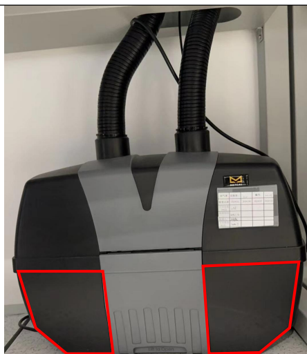
双工位便携式过滤装置排放口
